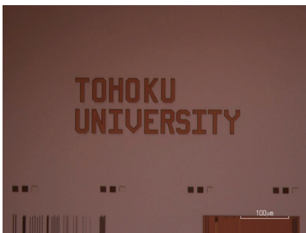
図 6 多結晶シリコン膜を堆積した石英基板上に電子線リソグラフィで形成したレジストパターン
