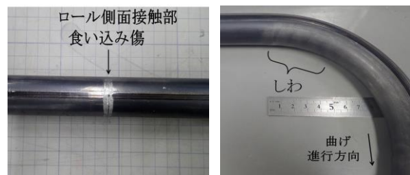
図10 マンドレル位置を変えた曲り管 (曲げロール押込み量 27.2 mm)
