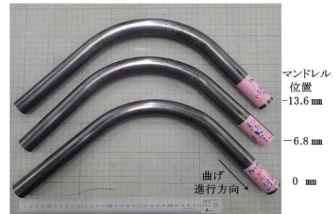
図10 マンドレル位置を変えた曲り管 (曲げロール押込み量 27.2 mm)
