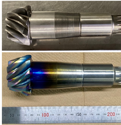
図 7 建設機械用スパイラルベベルギア歯面上に炭素イオン流蒸着法により DLC 膜を成膜した前後の外観写真。複雑な 3 次元形状を有しているにも関わらず DLC 膜は均一に成膜されている様子を確認できる
